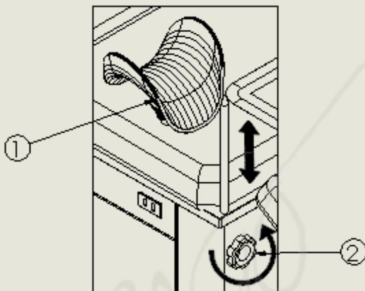
El restirador (1) se desliza sobre correderas jalándolo para colocarlo en la posición deseada.
