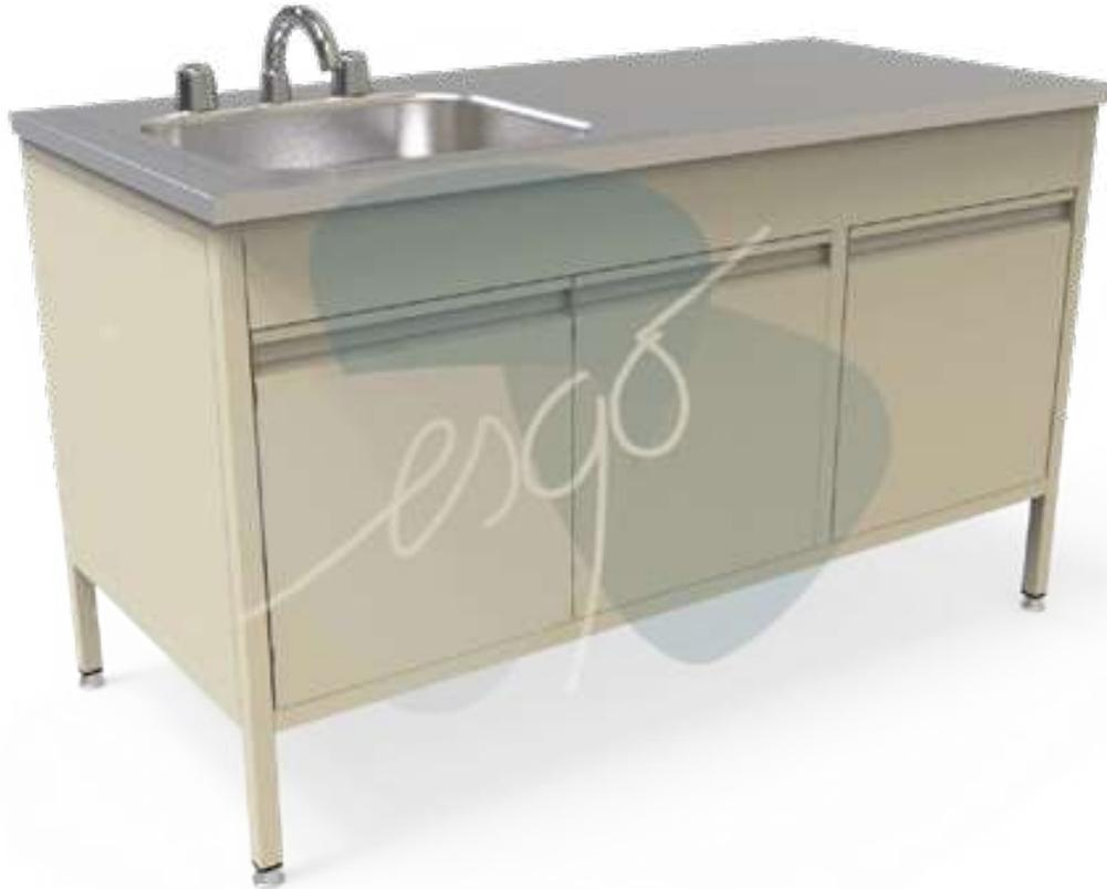
Cubierta y borde perimetral en láminade acero inoxidable Calibre No. 14 Tipo AISI-304 sin respaldo y con fregadero derecho de 50 x 50 x 35 cm, acabado pulido. Estructura fabricada en lámina y perfil tubular de acero con acabado en esmalte alquidálico electrostático horneado. Regatones de aluminio de altura ajustable.
